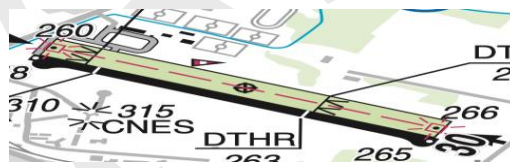
Câble de treuillage au centre de la piste planeurs, utilisable aux deux QFU (2 témoins lumineux) (Source de l'image : SIA)
