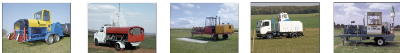
Exemples de treuils utilisés par les clubs de vol à voile (Source : FFVP/CNVV)
